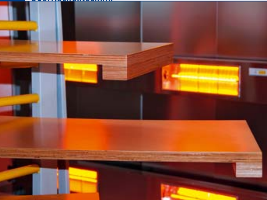
Schnelle Welle: Die meisten Lacke trocknen unter Halogenstrahlung so schnell ab, dass die Werkstücke, je nach Lack, teilweise bereits nach 10 Minuten schleifbar sind. Die Trocknung von innen nach außen sorgt zudem für einen sehr guten Verlauf
