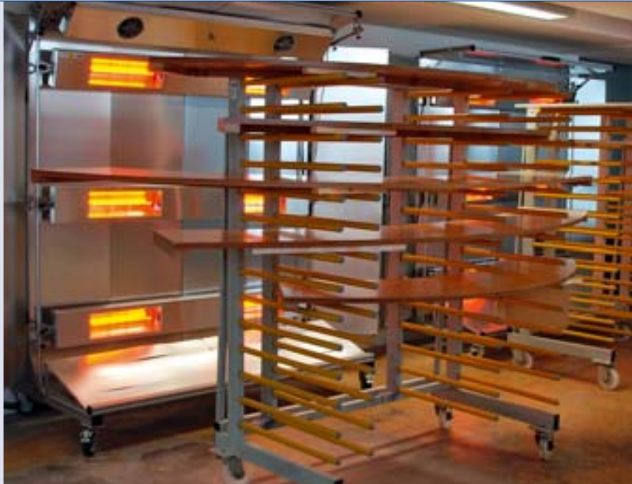
Die Halogentrocknung ist einfach und unkompliziert in der Handhabung sowie darüber hinaus auch wartungsfrei. Ein großer Pluspunkt der Technologie besteht darin, dass sie für alle Lacke gleichermaßen einsetzbar ist (BM-Fotos: Christian Nördemann)
